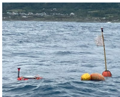
台湾台東の定置漁場にブイを設置して、波高・潮流、水温データを取得
