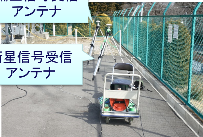
アンテナ設置状況(センチメートル級)
