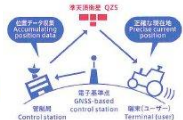
電子基準点の高精度測位情報を用いたセンチメータ級サービス
