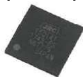
日本無線 SLAS対応チップ(JG11) 9.0 × 9.0mm
