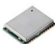
古野電気 受信モジュール(GN-87) 12.2 × 16.0 × 2.8mm
