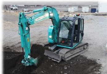
合同会社ビスベル 油圧ショベルとダンプトラックによる残土搬出自動化システム
