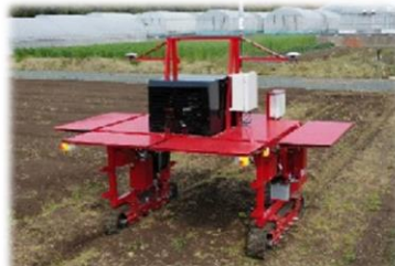
カワサキ機工株式会社 農業用クローラ型自律走行車両
