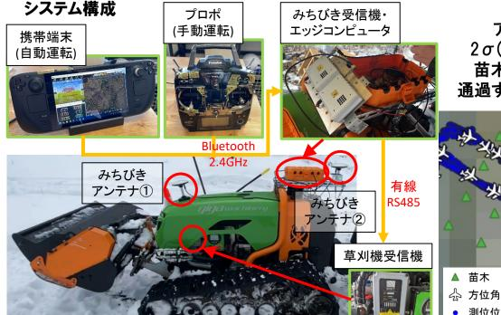
移動体測位結果 アンテナ2点間距離 2σ(95%)=4.0cmの精度で 苗木間隔2.23mの中心を 通過する走行軌跡を得られた
