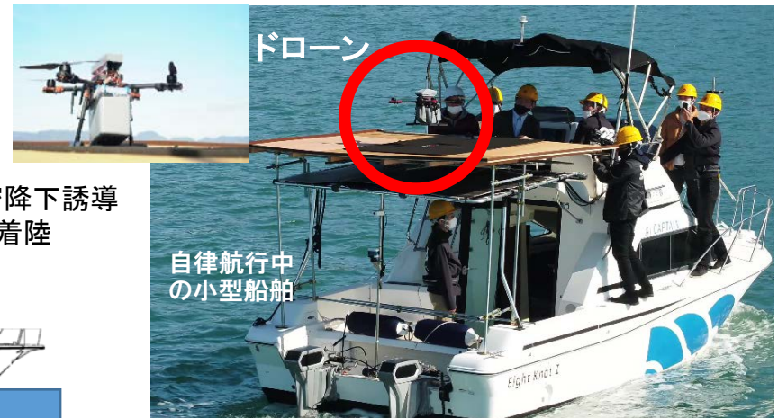
図2 6km/h航行中でのドローン着陸直前の様子
