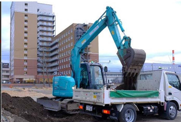
CLAS等を活用した無人の油圧ショベルが自律的に前方の土を掘削し、隣接するトラックに積み込むことができた。(2021年2月報道)
