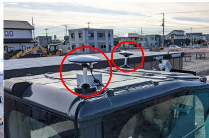
みちびきのアンテナは、天井に2機対角に設置しアンテナ間距離は1.7mであった。機体の向き(掘削する位置の左右に相当)をリアルタイムに認識した。
